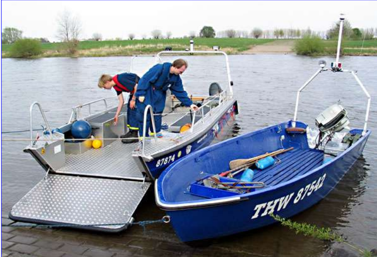
links Mehrzweckarbeitsboot mit absenkbarer Bugrampe, rechts Mehrzweckboot (auch „Sturmboot“)
